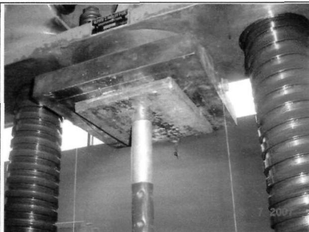
Fotografía 8. Vista del montaje superior de pie derecho
