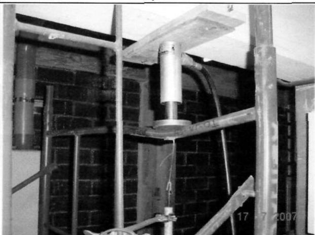
Fotografía 12. Falla por deformación del travesaño.
