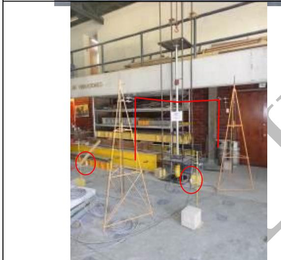
**Fotografía 3.3:** Detalle del sistema de medición de deformación horizontal del punto medio de la alzaprima.
