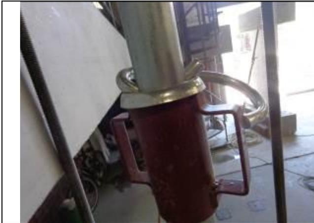
**Fotografía 4.1:** Detalle de la flexión plástica que presenta el pasador de fijación de altura. Probeta ECA-SOLPAC-N-H239-01
