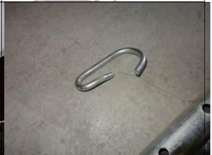
**Fotografía 4.4:** Detalle posterior al ensayo del nivel de deformación residual del pasador. Probeta ECA-SOLPAC-N-H303-01
