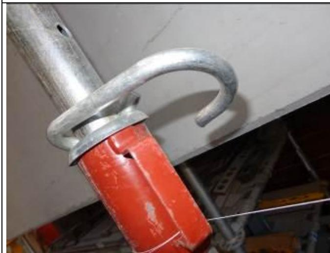
**Fotografía 4.3:** Detalle de la flexión plástica que presenta el pasador de fijación de altura. Probeta ECA-SOLPAC-N-H303-01
