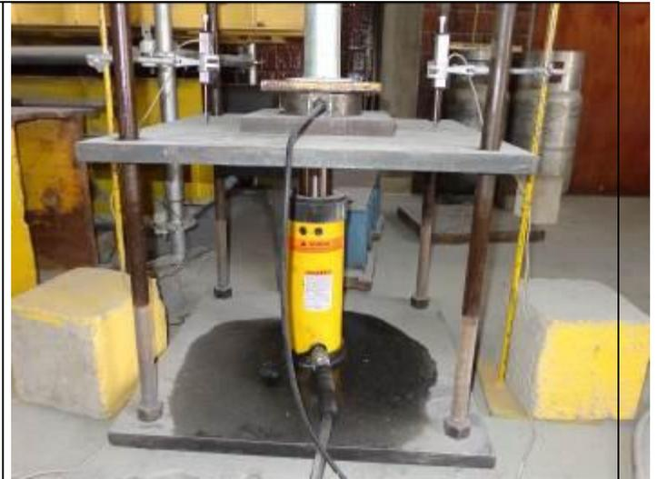
**Fotografía 3.2:** Detalle del gato hidráulico inferior, el cual genera la sollicitación de carga sobre la alzaprima
