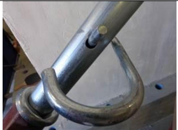
**Fotografía 4.2:** Detalle posterior al ensayo del nivel de deformación residual del pasador. Probeta ECA-SOLPAC-N-H239-01
